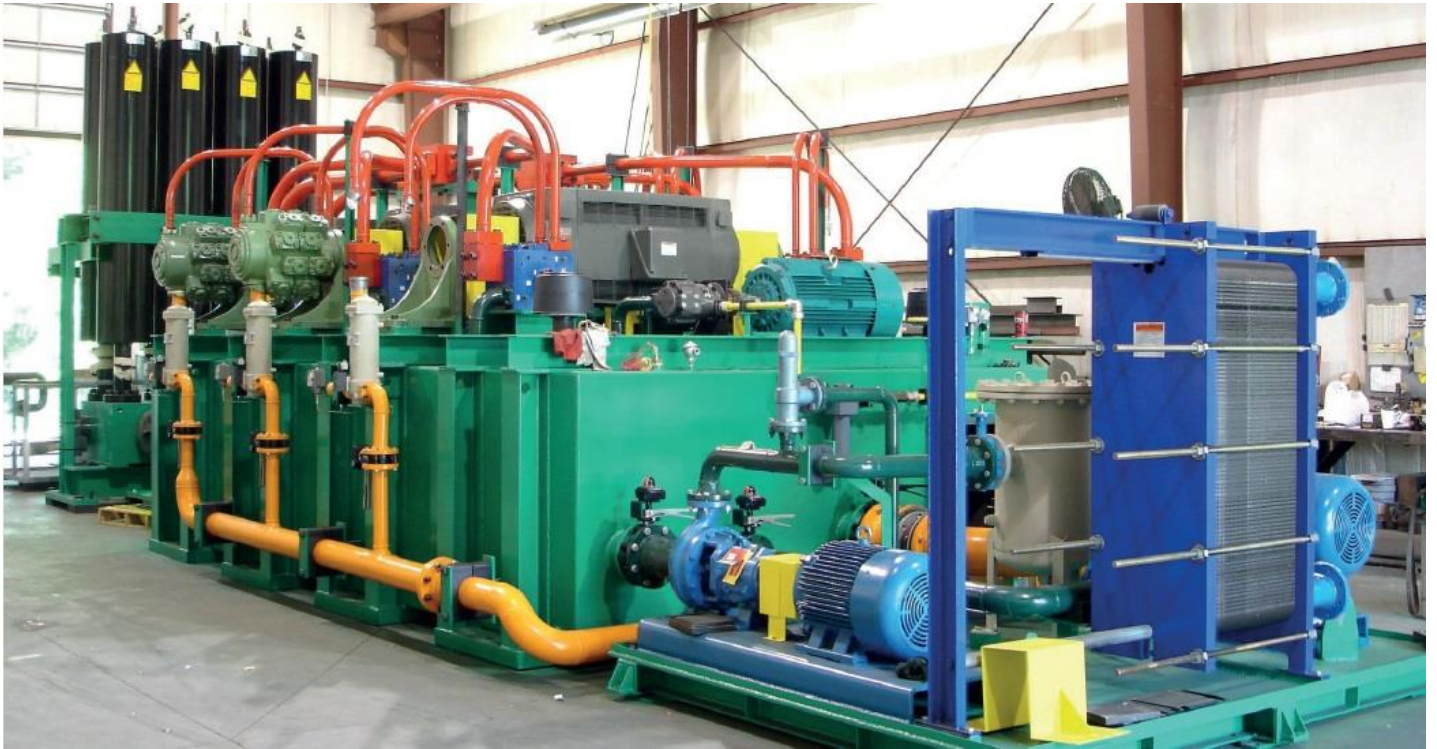
Hydraulický pohon zápusťového lisu 100 MN v USA s 8 konstantními čerpadly série RF.
