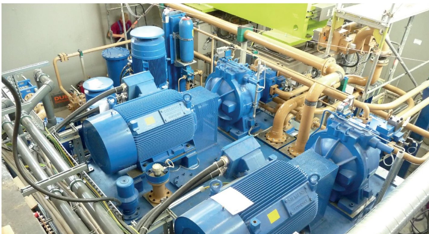
Hydraulický PMSD pohon speciálního lisu pro univerzitu ve Freibergu s 2 regulačními čerpadly řady RX.
